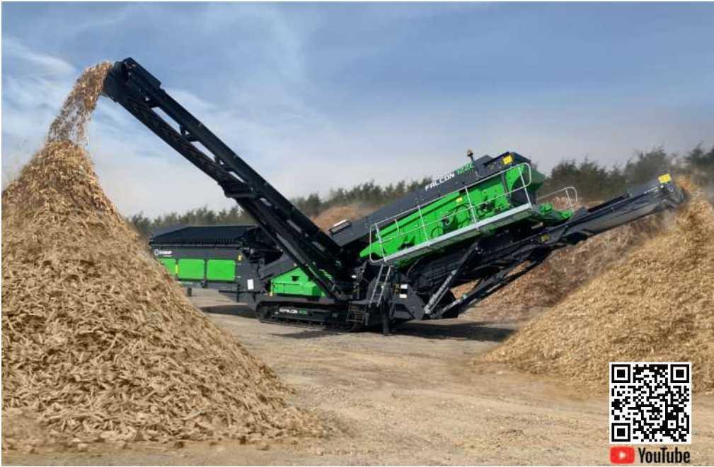
EvoQuip Falcon 1230 Klassiersieveanlage 4 Fraktionen
