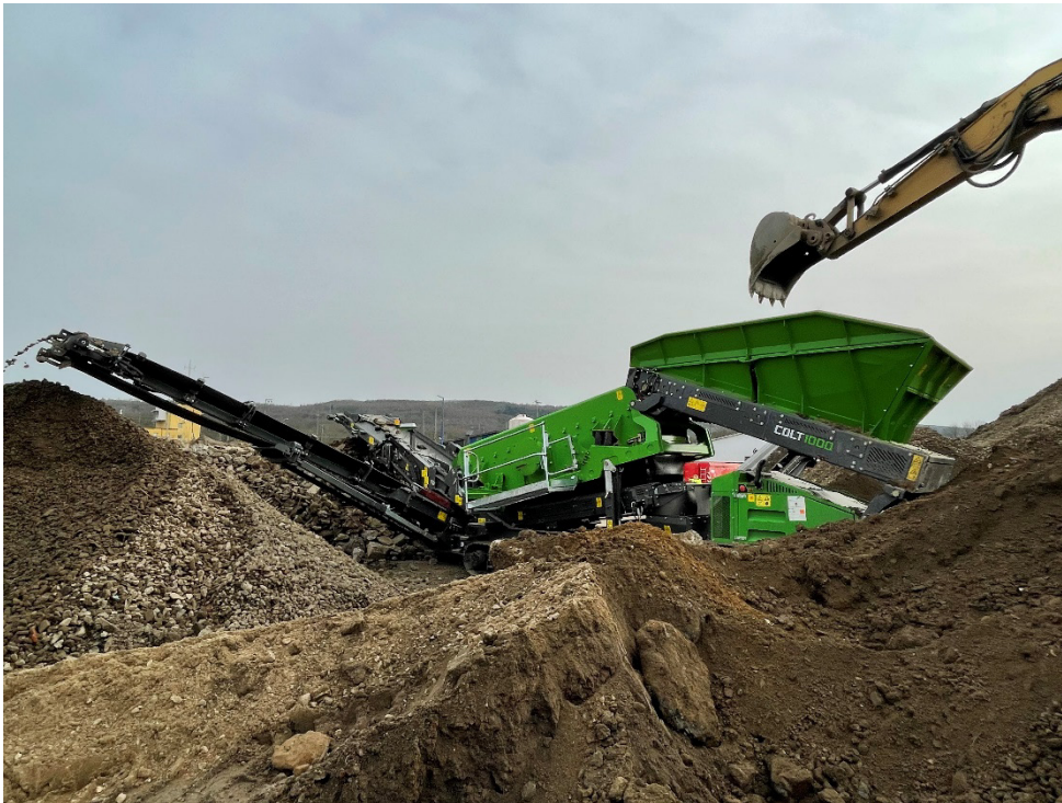
Abb.: Die Terex EvoQuip Colt 1000 muss bei der GRE-Gräwe in Hagen mit angeliefertem Schutt aller Art zurecht kommen können und hat sich schnell als Rückgrat der Aufbereitung erwiesen.
