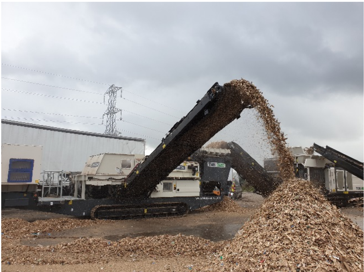
Abb. 2: Der Metallabscheider kann durch seinen großen Aufgabetrichter von leistungsstarken Baumaschinen oder vorgeschalteten Siebanlagen beschickt werden.
